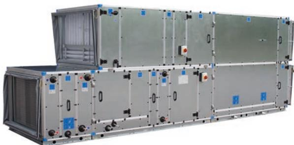
Die modularen Lüftungsgeräte TopAir dienen der zentralen Luftaufbereitung mit allen grundlegenden Funktionen wie: Heizen, Kühlen, Filtration, Befeuchtung, Entfeuchtung, Wärmerückgewinnung und -regeneration. Mit Luftströmungsvolumina von 1000 m<sup>3</sup>/h bis zu 100 000 m<sup>3</sup>/h weisen sie exzellente thermische und akustische Isolationseigenschaften sowie Gehäusefestigkeit auf und bieten eine Auswahl an kundenspezifischen, funktionellen Elementen.
