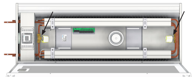
Bild 22. Bei 4-Rohr Ausführung werden zwei Ventile und Stellantriebe in die Rohrleitungen integriert (Ein Ventil wird gegenüberliegend der Anschlussseite montiert).
