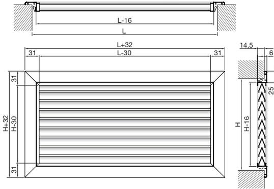
**AT-21** - 25 mm Rahmen + Gegenrahmen - mit V-förmigen, feststehenden Lamellen.
