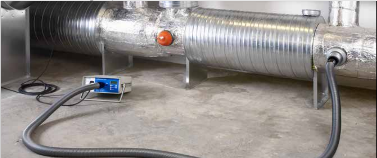
Bild 3: Verbindung zum Luftleitungssystem
