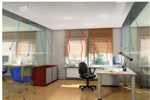
Bild 2: Celo basiert auf einer einzigartigen Technik, die es ermöglicht, die gekühlte Luft durch Schlitze in der Zwischendecke entlang der Wand bis zum Boden zu leiten.
